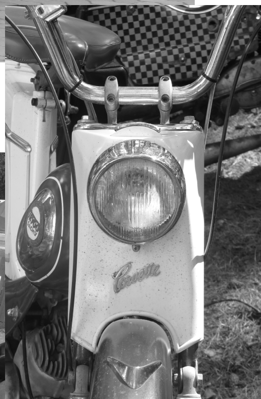
Trygg Corvette med Sachsmotor, norsk moppe som bygger på Rex Comet. 60-talare.
