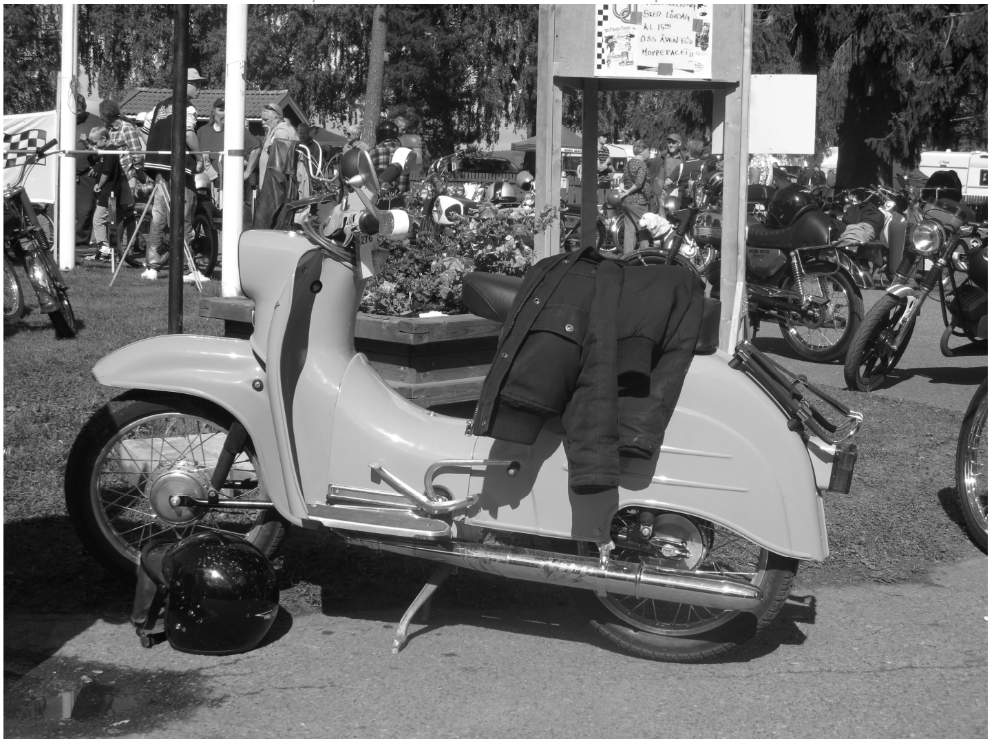
En Simson Schwalbe KR51 i fint skick. Tillverkades 1964-1986 av IFA i Östtyskland. Egna motorer och 3 eller 4 växlar drog upp det 80 kg tunga ekipaget till 60 km/h. Simson var DDR:s svar på Kreidler. Simson importerades nog inte till Sverige.
