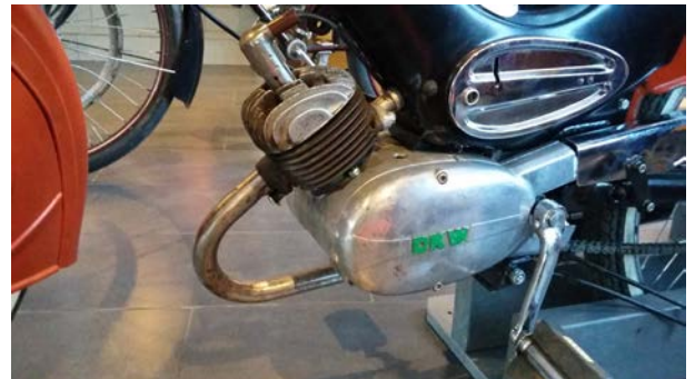
Eldrift ligger i tiden. Det är entusiasten Stefan Tamm med son som vinterjobbat. Elmotorn ligger innanför kåporna på oljebrännaren från DKW
