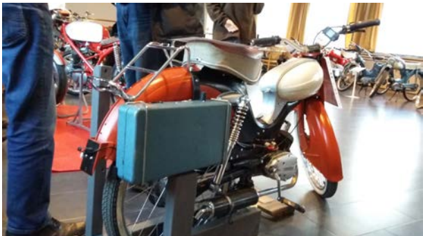
Eldrift ligger i tiden. Det är entusiasten Stefan Tamm med son som vinterjobbat. Elmotorn ligger innanför kåporna på oljebrännaren från DKW
