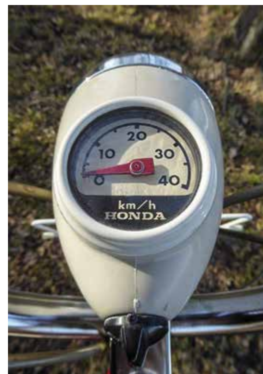
Hastighetsmätaren graderad till 40 km/tim. I denna mätare kunde det också stå "Little Honda". Svart vred för belysning.
