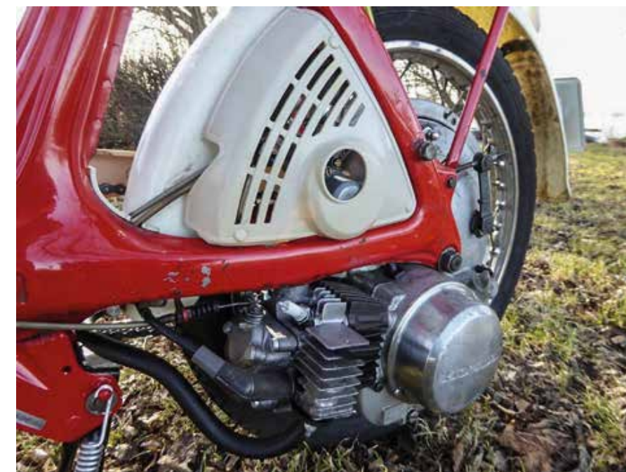
Ett par närbilder på motorn. Ovan ser vi också kåpan som täcker förgasaren.
