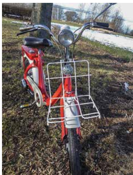
Ovan: Original sitter det en pakethållare fram överdragen med något plastliknande material i samma kulör som skärmarna.
