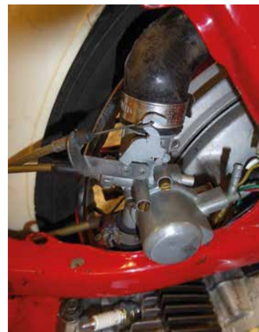
Förgasaren är placerad ovanför motorn vid sidan av bakhjulet.
